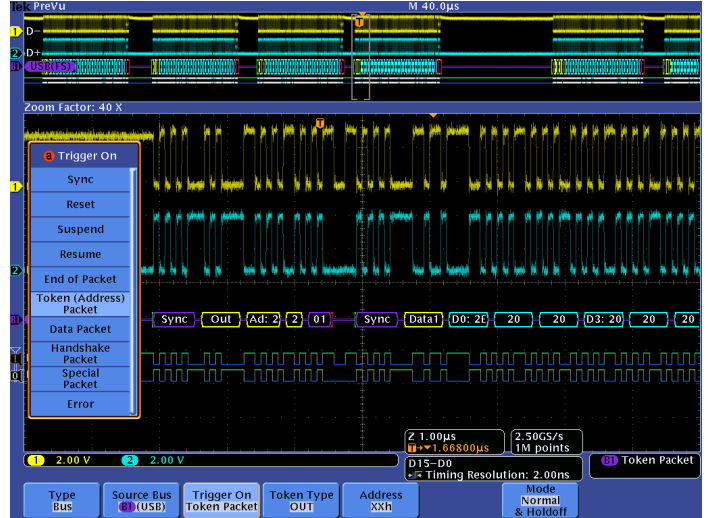
USB 최대 속도 시리얼 버스에서 특정 OUT 토큰 패킷을 트리거합니다. 노란색 파형은 D+, 파란색 파형은 D-입니다. 버스 파형은 Start, Sync, PID, Address, End Point, CRC, Data 값 및 Stop을 포함하여 디코드된 패킷 내용을 제공합니다.
