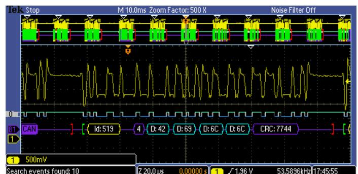
검색 단계 2단계: Wave Inspector는 자동으로 레코드를 검색하고 각 이벤트별로 하얀색의 트라이앵글 기호를 이용하여 표시를 합니다. Previous(이전) 및 Next(다음) 버튼을 이용하여, 다음 이벤트로 곧바로 이동 가능.
