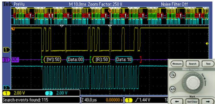
검색 – I<sup>2</sup>C 디코드는 어드레스 값 50에 대한 Wave Inspector의 결과를 보여 줍니다. Wave Inspector 컨트롤은 파형 데이터를 보고 탐색 기능에서 기대 이상의 효율을 제공합니다.
