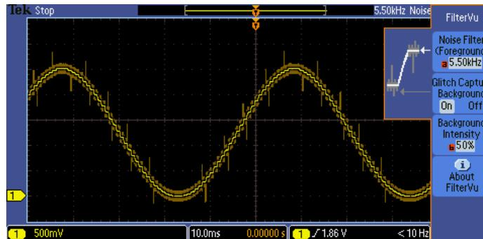
DAC 신호 출력- FilterVu™는 5.5kHz를 초과하는 모든 주파수를 제거하여 노이즈가 없는 DAC 단계를 전면 웨이브폼(황색)에 선명하게 표시합니다. 또한 FilterVu는 오실로스코프의 전체 대역 폭까지 고주파 글리치를 캡처하여 배경 웨이브폼(주황색)에 표시합니다.
